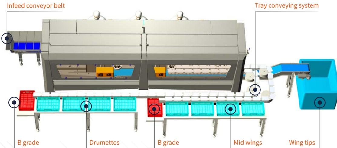
El SmartWing es capaz de procesar hasta 8,000 alas por hora. Puede procesar alas izquierdas y derechas al mismo tiempo. Las alas se cargan en soportes fáciles de alimentar. Una vez cargadas, las alas se posicionan y se escanean con cámaras que buscan el tamaño y la calidad. Los datos de las imágenes recopiladas se analizan con el software interno de IFEC, basado en inteligencia artificial. Se seleccionan los grados B y, posteriormente, se descargan del sistema.
