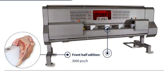
La BMH edición mitades delanteras tiene una capacidad de 3000 piezas por hora. Las mitades delanteras se cargan manualmente en conos especialmente diseñados, equipados con un mecanismo de bloqueo que garantiza una alineación perfecta. Gracias a un módulo adicional precortado, la carne trasera y las canales restantes se separan y descargan automáticamente. El producto final es una hermosa pieza de carne de lomo apta para su posterior procesamiento.
